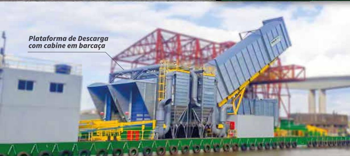
*Plataforma de Descarga com cabine em barcaça*
